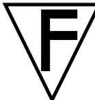
Leuchten, geeignet zur Montage auf normal entflammaren Befestigungsflächen
